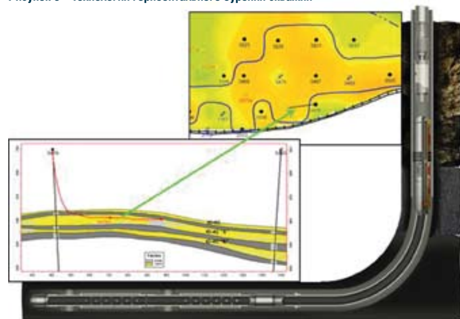
Рисунок 3 – Технология горизонтального бурения скважин
