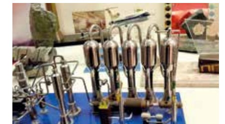
Установка по опреснению морской воды
