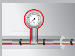
Обогрев контрольно-измерительных приборов (КИП)
