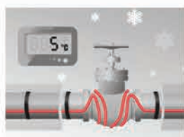
Защита труб от замерзания
